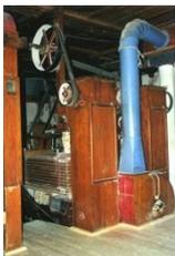
Über dem Walzenstuhl arbeitet der **Plansichter** in horizontalen Schwingbewegungen und trennt die verschiedenen Mehlqualitäten. Die Förderung der Mehle erfolgt mittels Becherelevatoren.
