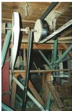
Bevor das Getreide, insbesondere aber der Dinkel, vermahlen werden kann, muss es mit der **Röndle** entspelzt und gereinigt werden. "Die Spreu vom Weizen trennen". Dinkelspreu eignet sich sehr gut als Kissen- und Matratzenfüllstoff
