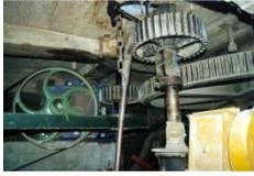
Das **Geschirr** (Getriebe) besteht aus 6 gusseisernen Zahnrädern. Die 3 grössten Räder sind mit Holzzähnen bestückt. Diese Zähne sind aus Weissbuche massgefertigt und müssen einzeln eingepasst werden.
