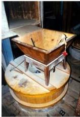
Der obere **Mühlstein** wird vom darunterliegenden Getriebe angetrieben, der untere ist fixiert. Das Korn wird oben in einen Trichter geschüttet und zwischen den Steinen vermahlen. Die Steine sind je 600 kg schwer und werden alle paar Jahre frisch geschärft.
