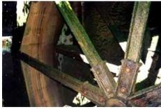
Das **Wasserrad** wird vom Mühlbach angetrieben, der im Oberbucheggberg entspringt und in Rüti in die Aare mündet. Das Rad hat 6 Meter Durchmesser und die Drehzahl beträgt 5 U/Min. Die Leistung entspricht ungefähr einem 5-PS-Motor
