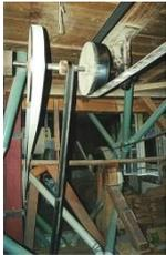
Die leichtzügigen Maschinen werden mit ledernen **Treibriemen** angetrieben. Diese befinden sich grösstenteils an der Decke der Mühle.
